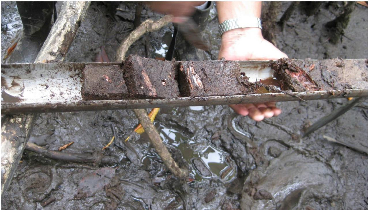
Figura 5. Demostración del muestreo de suelo, con el detalle de la extracción de una muestra de volumen conocido para la determinación de densidad aparente del suelo en el Humedal Nacional Térraba-Sierpe. Foto: Miguel Cifuentes.
